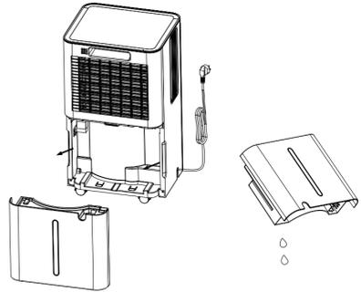
**Bemerkung:** Entfernen Sie keine Magnete oder andere im Wasserbehälter befindliche Elemente, da sonst die Entfeuchtung nicht angehalten wird, wenn er voll ist.
