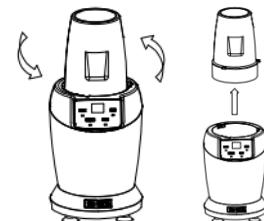
**Upozornenie:** Základňa mixovacích nožov obsahuje tesnenie, ktoré zaistuje vodotesný spoj s nádobou. Po každom umývaní sa uistite, že je tesnenie na svojom mieste a nie je poškodené.
