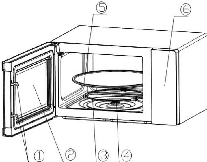
1. Bezpečnostný uzatvárací systém dvierok
