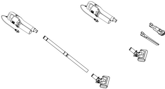
**Hinweis:** Der Bürstenaufsatz ist motorisiert. Berühren Sie den Aufsatz nicht, während das Gerät in Betrieb ist, um Verletzungen zu vermeiden. Schalten Sie das Gerät immer aus und trennen Sie es vom Stromnetz, bevor Sie mit der Bürste hantieren.
